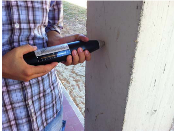
Prove sclerometriche sulle colonne del portico nella facciata Sud dell'Ampliamento Scuola Materna
